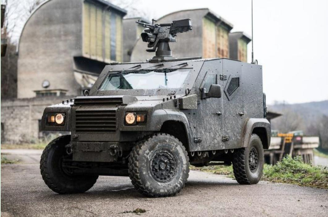
***Les protections balistique, anti-mine et anti-IED du Dagger sont aux normes STANAG 4569.***
