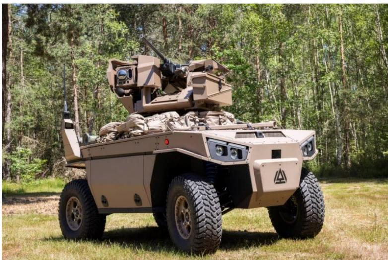
Doté d'une propulsion hybride électrique/diésel lui assurant une mobilité discrète, le DRAILER est un robot aux technologies éprouvées, possédant une autonomie adaptée aux théâtres d'opérations. Robot polyvalent, c'est un compagnon de taille sur le terrain ! Il peut opérer une charge utile jusqu'à 700 Kg, tout en ayant une capacité de franchissement répondant aux attentes de la haute intensité.
