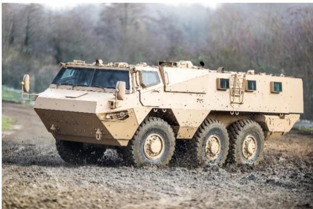
Compact et protégé, le VAB MK3 assure furtivité et discrétion sur le champ de bataille tout en embarquant jusqu'à 12 hommes sous protection balistique et mines. Sa capacité d'emport lui permet l'intégration d'armements de moyen calibre jusqu'aux systèmes d'armes lourds (calibre 90mm, système de lutte anti-aérienne, porte mortier etc.).
